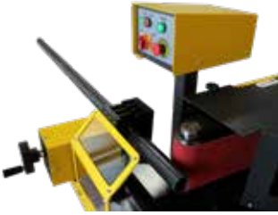
Dikey çalışma ile borunun ortasına kurtağzi açma Notching the middle of the pipes with vertical position.
