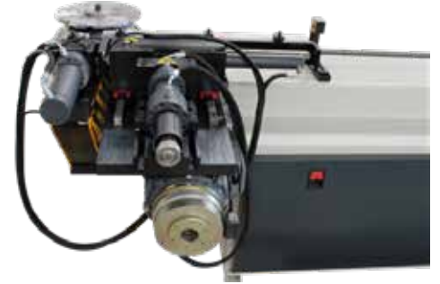
90NC lerde Direkt Tahrikli Redüktör Sistemi Direct Driver Reducer System for 90NC
