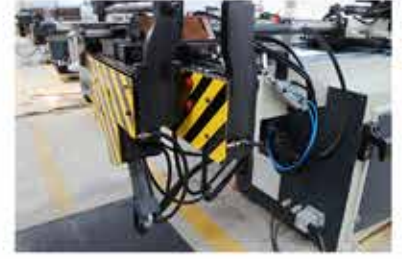
Büküm Kafası Önünde Ve Arkasında Güvenlik Sacı Safety Plate on Front And Back Of Bending Head
